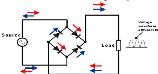
Figure 2. Rectifier circuit
