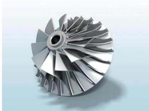
Fig. 1 : Centrifugal Compressor
