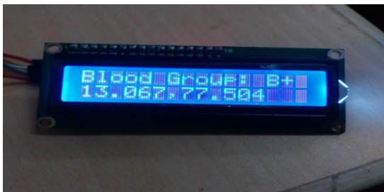
Fig 4.6: Blood group, latitude and longitude displayed on LCD
