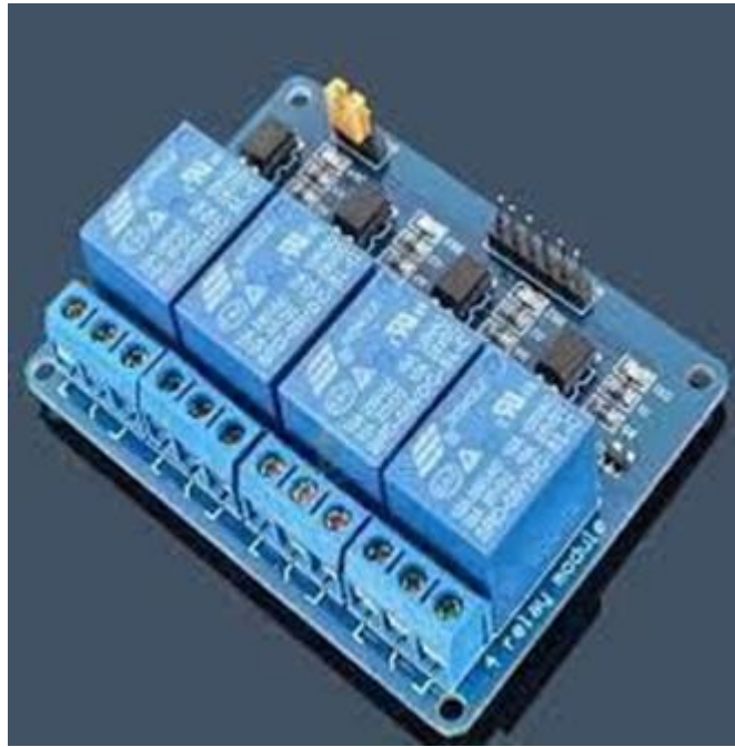
Fig. 7. 12V Relay module
